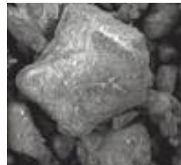
AIR-N-GO «Classic» Partikel mit abgerundeter Struktur x 1000
