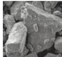
AIR-N-GO «Classic» Partikel mit abgerundeter Struktur x 1000
